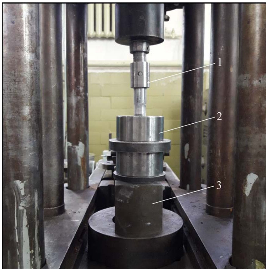
Рис. 3.8. Модернізований експериментальний штамп для прямого видавлювання високих ковпачків на універсальній випробувальній машини УІП-50: 1 – пуансон; 2 – матриця; 3 - підставка
