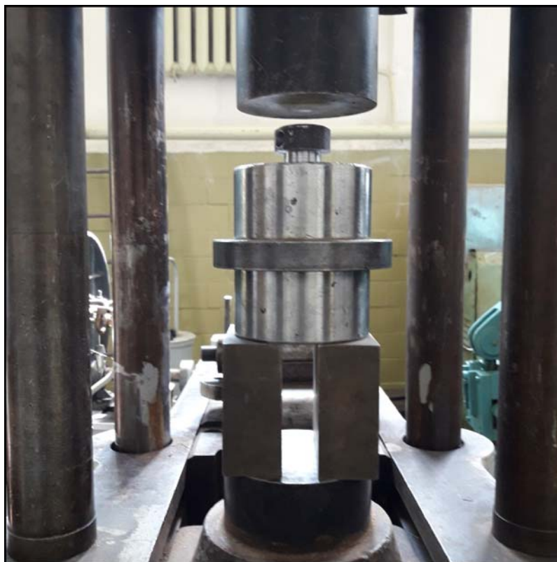
Рис. 2.3. Експериментальний штамп, що встановлений на універсальну випробувальну машину УИП-50
