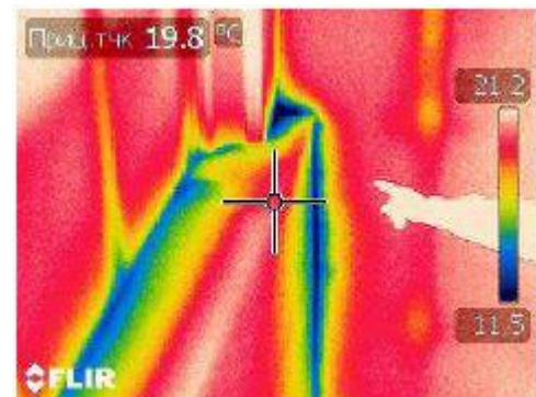
Рис. 2.25 – Термограма внутрішньої поверхні вузла під час вітру
