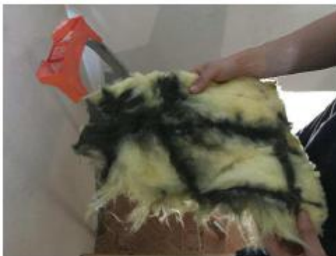
Рис. 2.5 – Наявність пилюватих відкладень в утеплювачі
