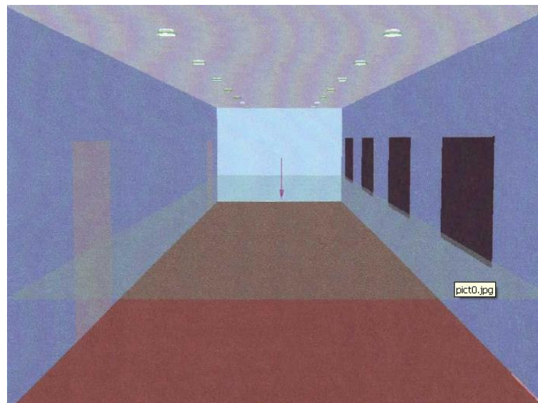
Рис. 9.6. Тривимірна модель приміщення заводоуправління з урахуванням розміщення світильників (до проведення модернізації)
