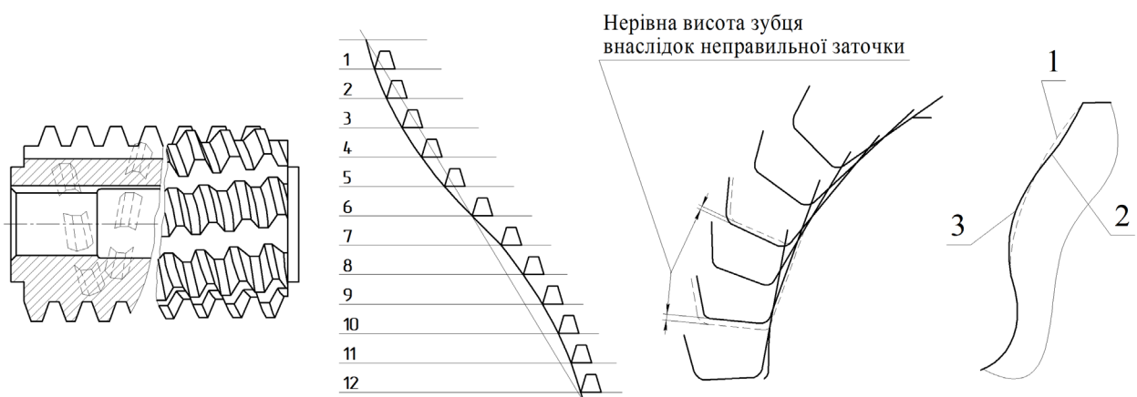
Рис. 2.10 Вплив відхилення вісєвого кроку фрези на точність
