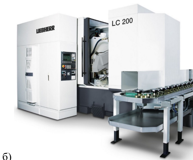
Рис. 2.27 Основні робочі рухи виконавчих органів (а) та зовнішній вигляд (б) зубофрезерного верстата.
