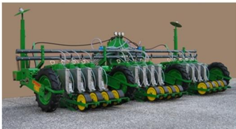
Рис. 3.4. Пневматична сівалка точного висіву Sfoggia Calibra (Італія)
