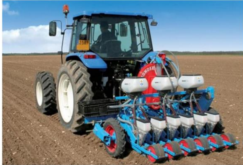
Рис. 3.3. Сівалка овочева точного висіву Monosem-MA.
