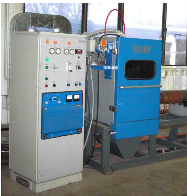
Рисунок 2.1 – Установка для напилення покриттів «PLAZER 30-PL-W»
