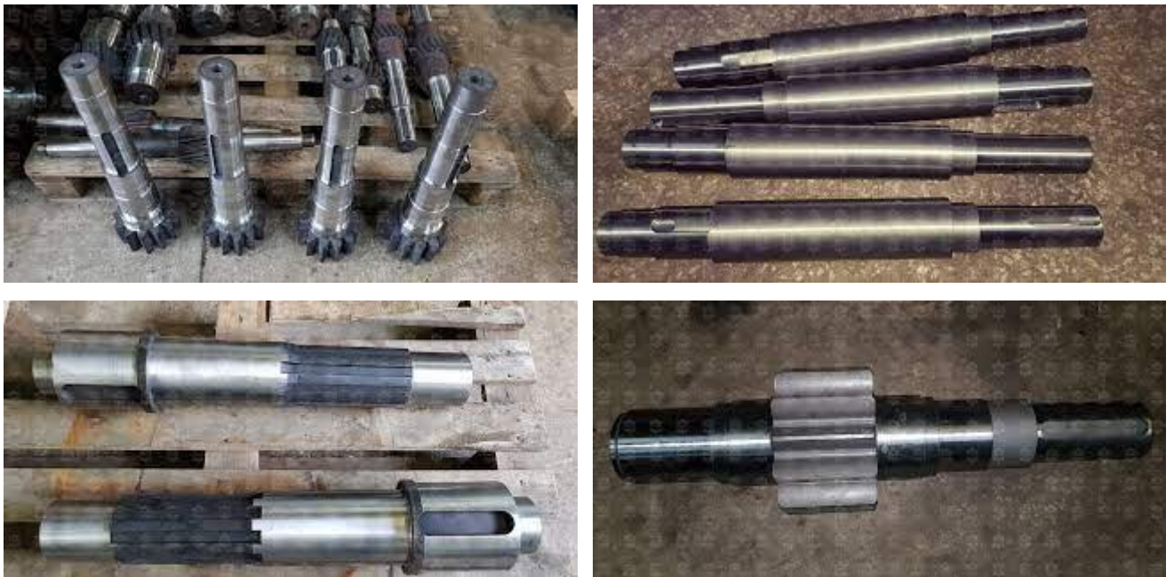
Рисунок 1.5 – Зношені поверхні валів с.г. та іншої техніки
