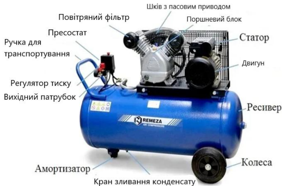
Рисунок 4.36 – Загальна будова поршневого електричного компресора.
