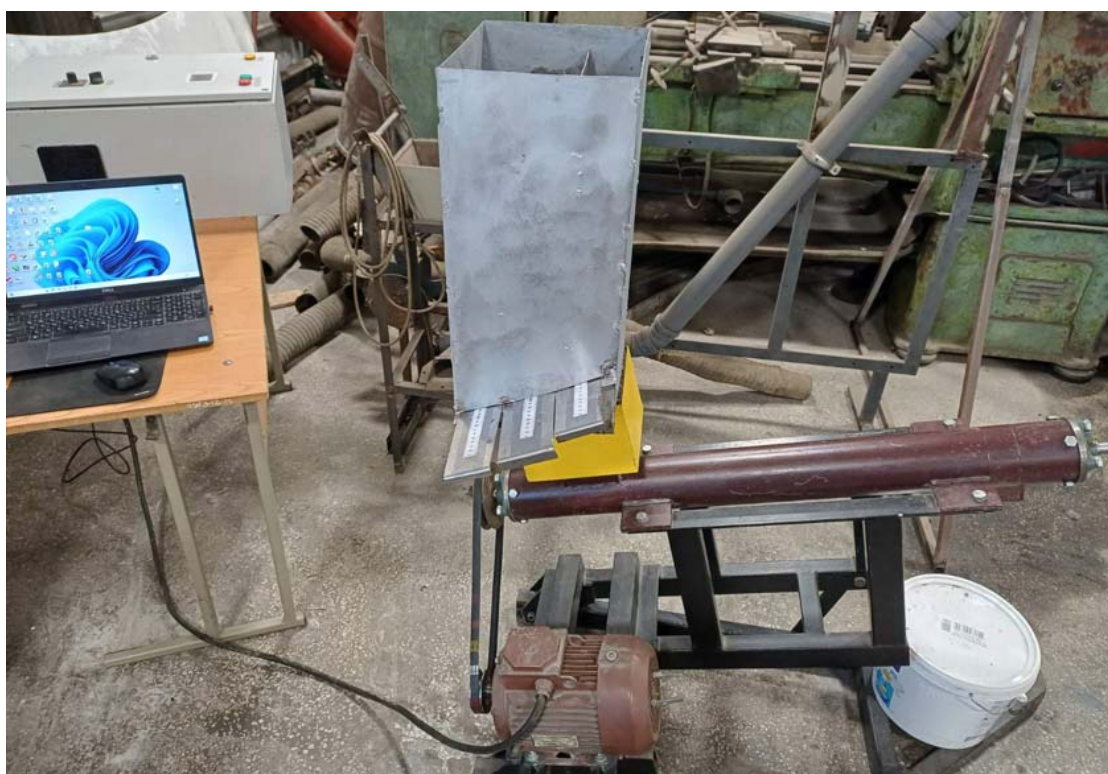
Рисунок 1 - Конструкція експериментальної установки для дослідження ефективності змішування сипких матеріалів гвинтовими робочими органами з додатковими елементами:
