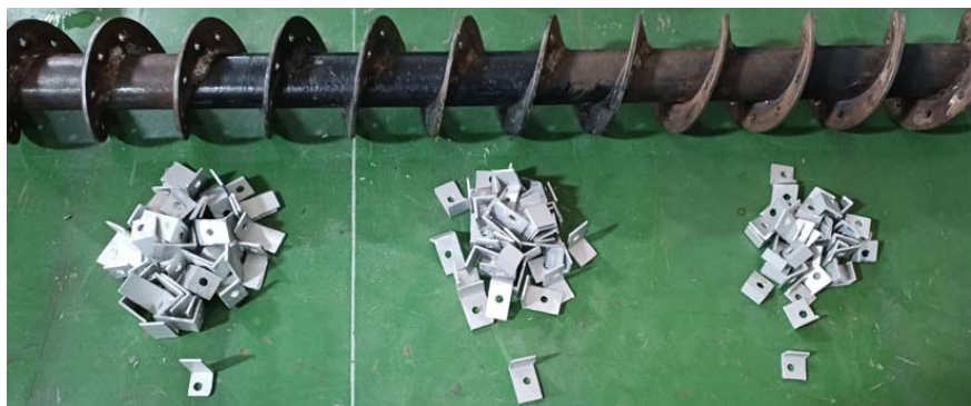
Рисунок 4 – Гвинтовий робочий орган з досліджуваними додатковими елементами
