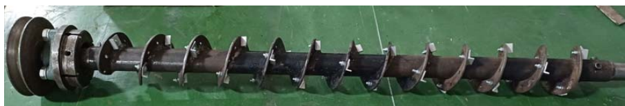
Рисунок 3 – Гвинтовий робочий орган оснащений досліджуваними додатковими елементами в підшипниковій опорі
