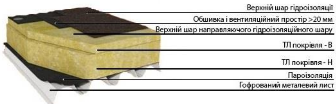
Рис.7.4 – Схема утеплення плоскої покрівлі мінеральною ватою
