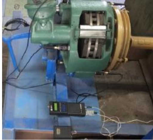
Рисунок 4.3 – Вібродатчики закріплені на площині супорта.
