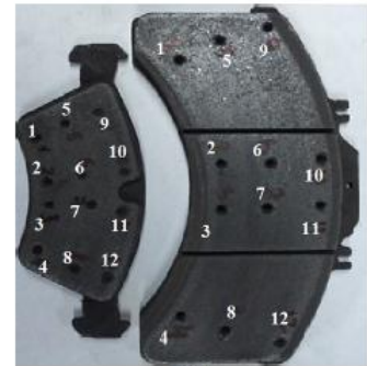
Рисунок 4.5 – Схема засвердлення отворів для визначення лінійного зносу накладки силового пристрою (а), загальний вигляд колодок легкового та вантажного автомобілів (б).
