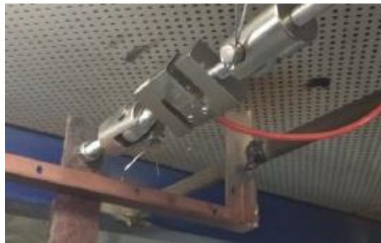
Рисунок 4.4 – Тензометричний датчик для визначення гальмівного моменту, що розвивається.
