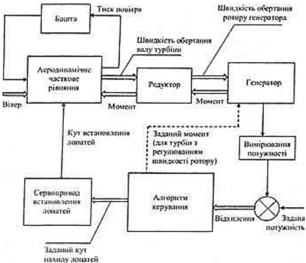
Рисунок 1.4- Загальний вигляд структурної схеми автономної системи електропостачання з використанням вітрових установок
