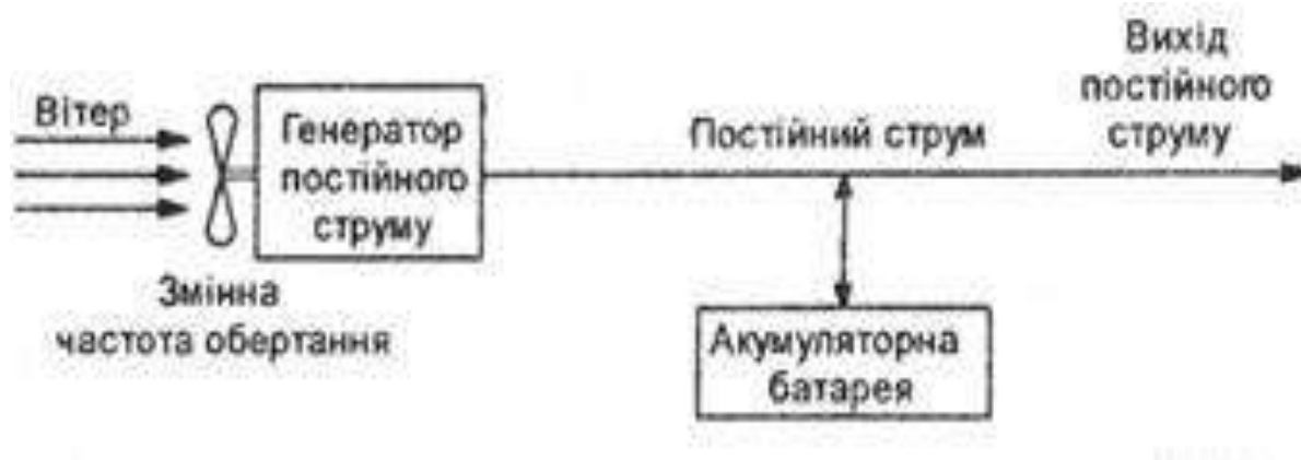
Рисунок 1.1 - ВЕС на шині постійного струму
