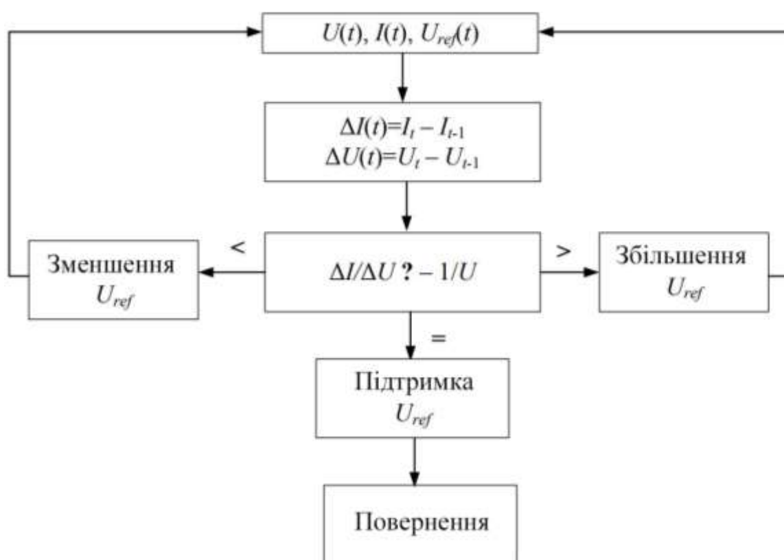
Рисунок 2.10 – Блок-схема роботи алгоритму доповненої провідності
