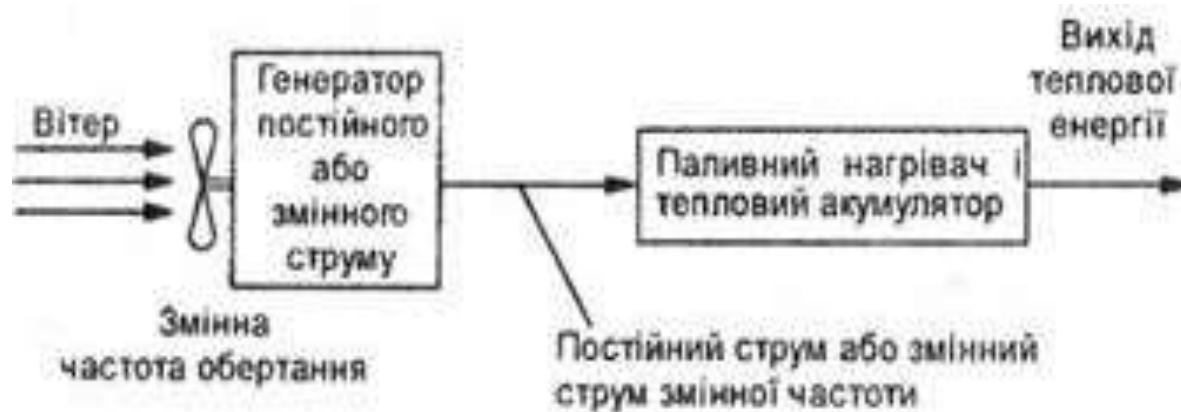
Рисунок 1.2 - ВЕС на шині з додатковим накопичувачем
