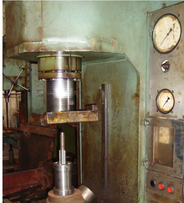
Рисунок 4 – Експериментальні дослідження з визначення зусилля дорнування напівкруглих канавок шліцьових валів на гідравлічному пресі мод. П6320
