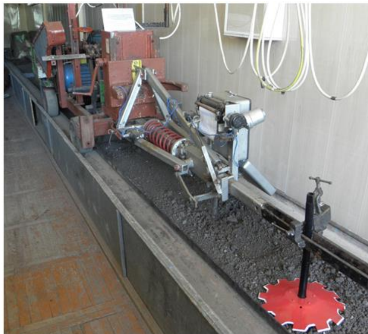
Рис. 3.2. Загальний вигляд лабораторної установки для дослідження параметрів функціонування дискового робочого органа.
