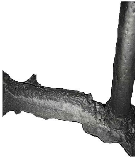
Рисунок 1.6 - Частина стояка та ливниково-живильної системи виливки «Корпус»
