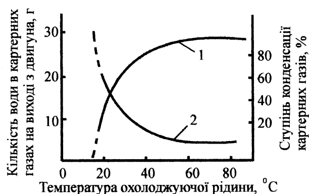
Рис. 2.10. Залежність кількості конденсату в картерних газах на виході з двигуна і ступеня їх конденсації в двигуні від його робочих температур (по воді та маслу):
