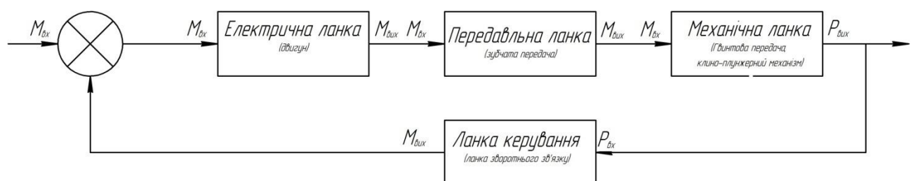
Рис. 3.7. Структурна схема механізму регулювання розміру
