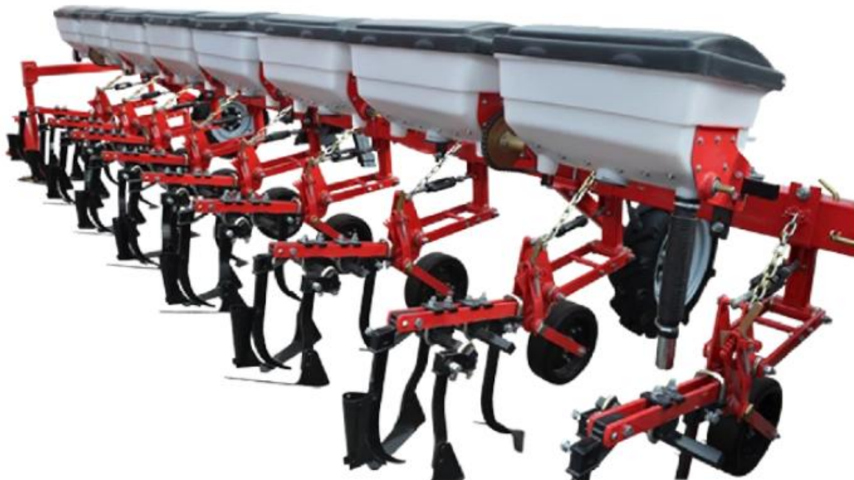
Рисунок 2.5 – Культиватор міжрядний КРН-5,6 від заводу виробника Avalon
