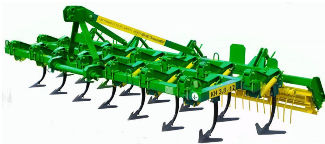
Рисунок 2.2 – Культиватор начіпний КН-3,8-12 виробництва «БілоцерківМАЗ»
