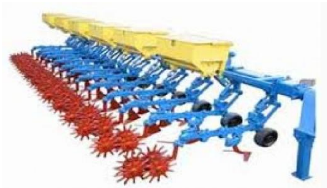
Рисунок 2.1 – Культиватор для міжрядного обробітку УСМК-5,4
