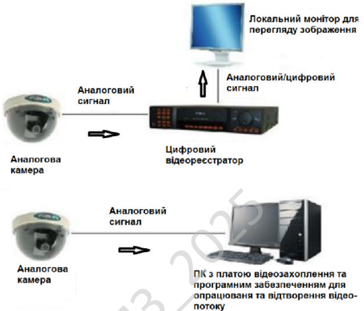
Рисунок 2.2 – Комбінована система відеоспостереження
