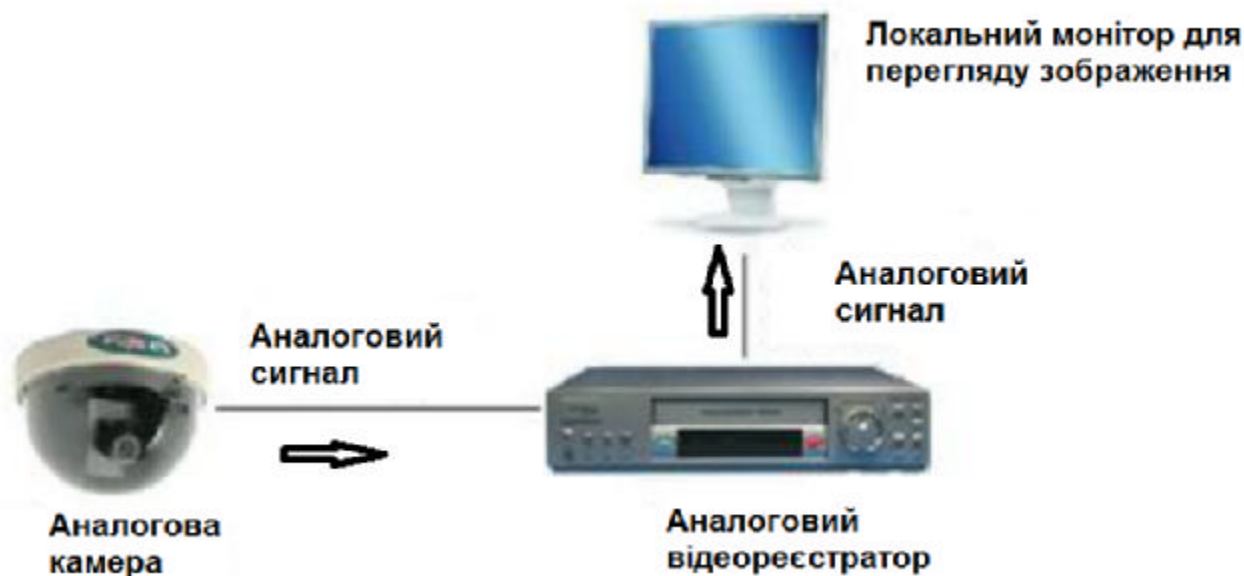
Рисунок 2.1 – Аналогова система відеоспостереження
