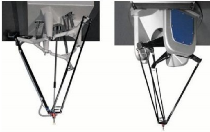
Рис. 1.5. Роботи типу «дельта» моделей C33 фірми «Demarex» і SE33 фірми «The SIG Group» (обидві – Швейцарія)
