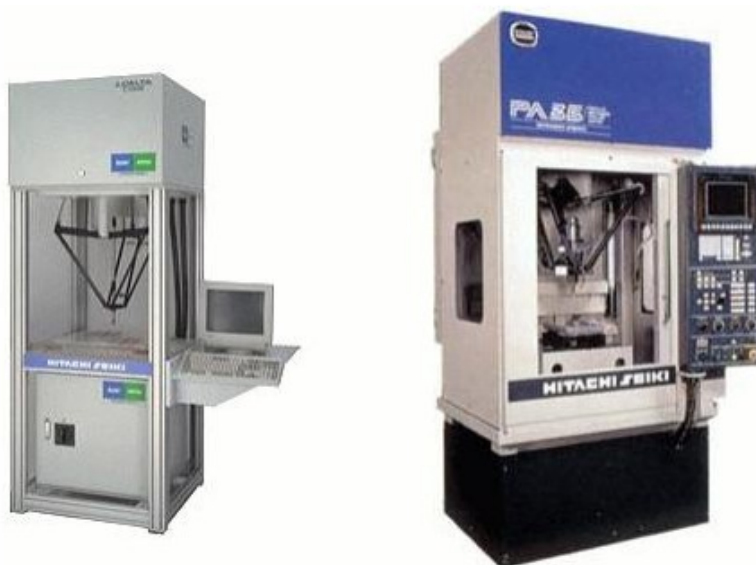
Рис. 1.3. Робот типу «дельта» фірми «Hitachi Seiki» (Японія)
