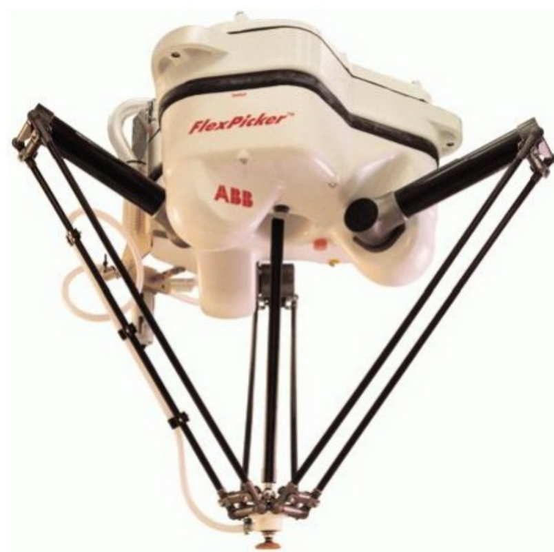
Рис. 1.4. Робот типу «дельта» FlexPicker фірми «ABB» (Швеція)
