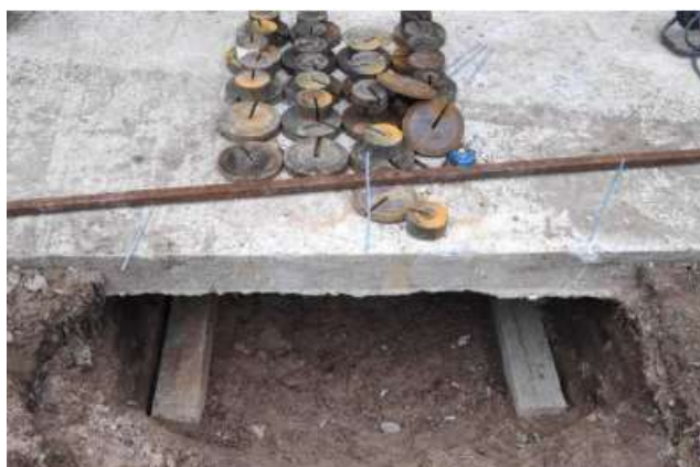
Рисунок 2.6 – Приямок із вкладеними лежнями.
