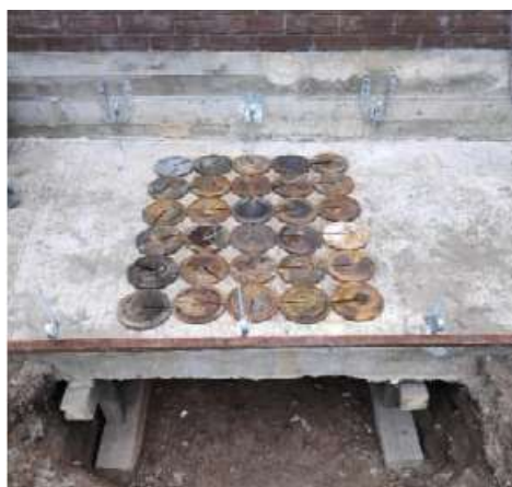
Рисунок 2.10 – Перша «ступінь» завантаження вантажами масою 3 кг.
