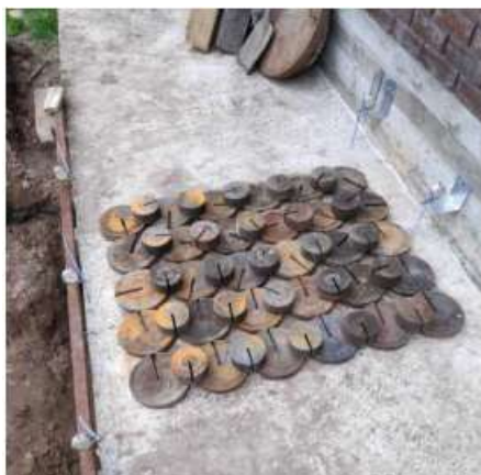
Рисунок 2.11 – Друга «ступінь» завантаження вантажами масою 4 кг.
