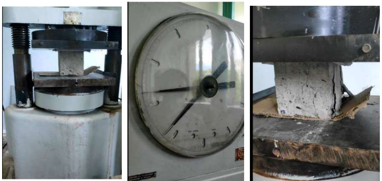
Рисунок 2.23 – Експериментальне встановлення міцності на стиск експериментального зразка бетону: кубика 3-1 шляхом руйнування на гідравлічному пресі (значення зусилля руйнування = 45000 кгс).
