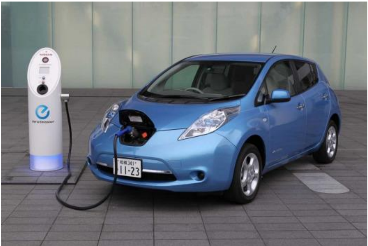
Рис.73. Проведення зарядки акумуляторної батареї електромобіля від електричної мережі
