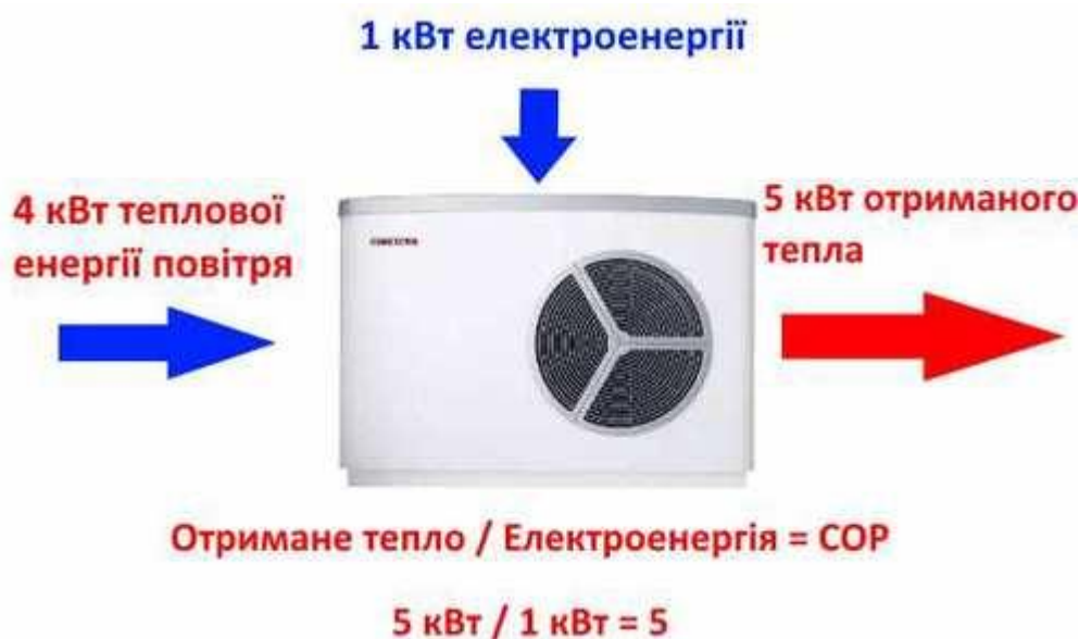
Рис.131. Ефективність роботи теплового насосу «повітря – повітря»
