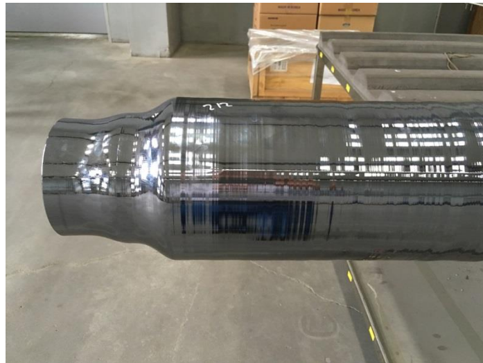
Рис.11. Монокристалічний кремнієвий злиток, отриманий за методом Чхоральського, перед розрізанням на пластини
