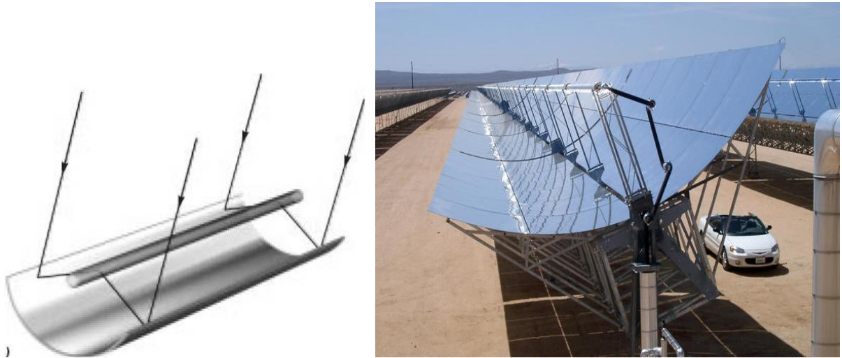
Рис. 38. Дзеркало концентратора параболоциліндричного типу
