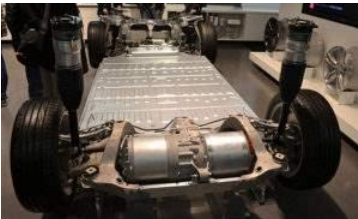
Рис. 72. Розміщення електродвигуна і платформи акумуляторної батареї на електромобілі
