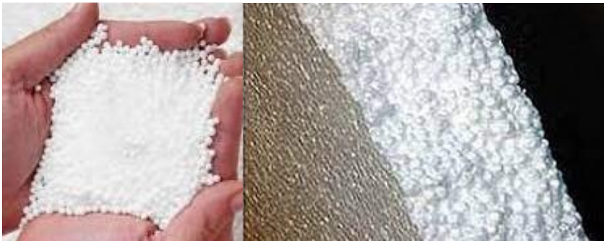
Рис.101. Сировинні гранули для виробництва пінополістиролу (а), структура зламу теплоізоляційної плити з пінополістиролу (б)
