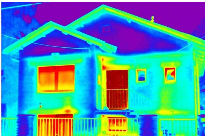
Рис. 91. Відображення на дисплеї тепловізора втрат тепла через огорожувальні конструкції будинку
