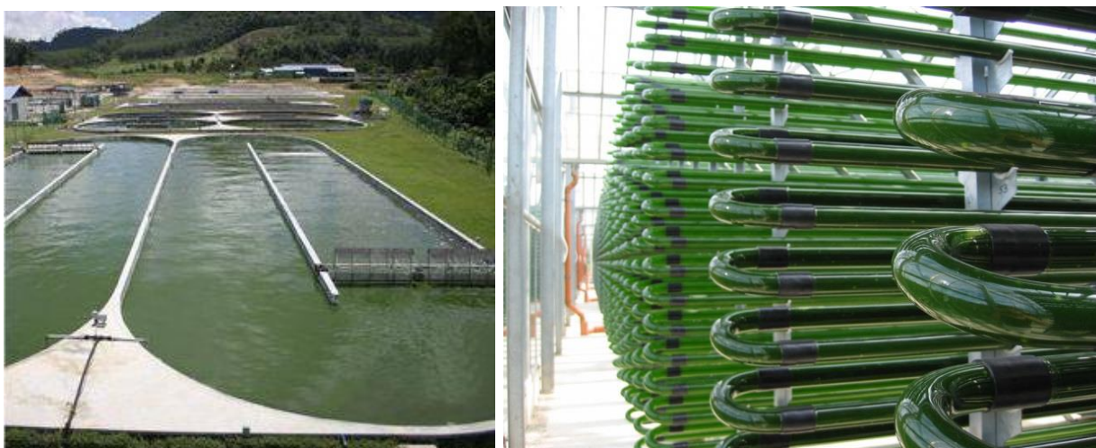
Рис.87. Біореактори для вирощування мікроводоростей: а – відкритого ставкового типу; б – трубчастий біореактор
