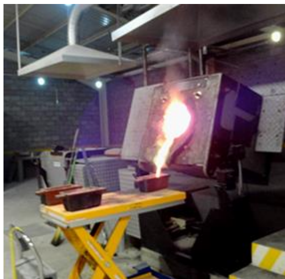
Рис. 139. Індукційна тигельна піч: а) конструкція печі: 1- індуктор; 2 – вогнетривкий тигель; 3 – металевий каркас печі; 4 – носок для зливання рідкого металу; 5 - кронштейн механізму нахилу печі; 6 – подова плита печі; б) нахил індукційної печі для зливу рідкого металу
