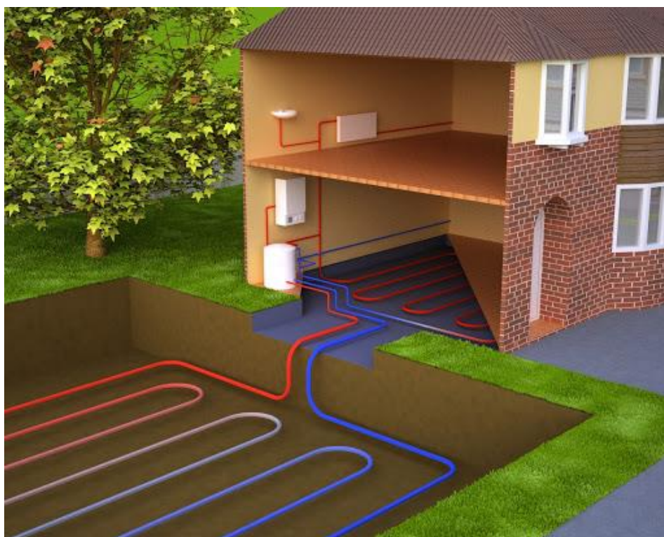
Рис.130. Схема розміщення елементів теплового насосу «ґрунт-вода»
