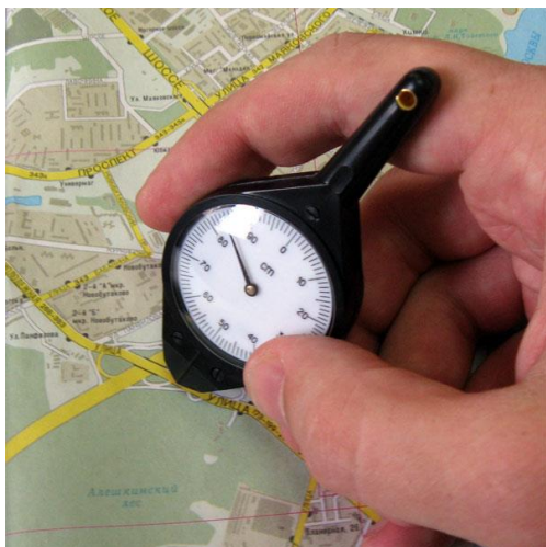
Рис. 2.2 Вимірювання курвіметром довжини лінії по карті
