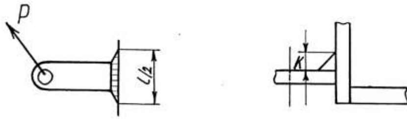
Рис. 8. Розрахункова схема зварного з'єднання подрібнювача незернової частини врожаю комбайна «Дон-1500Б»
