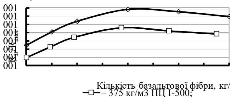
Рисунок 4 – Залежність зміни міцнісного параметру цементобетону при згині від кількості введеної базальтової фібри та кількості портландцементу
