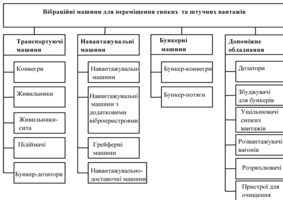
Рисунок 2 – Класифікація вібромашин для випуску, доставки, навантаження і транспортування сипких та штучних вантажів
