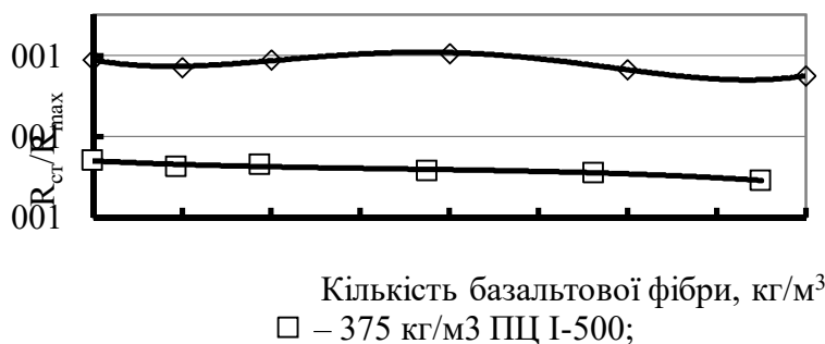
Рисунок 2 – Залежність зміни міцнісного параметру бетону при стиску від кількості введеної базальтової фібри та кількості портландцементу
