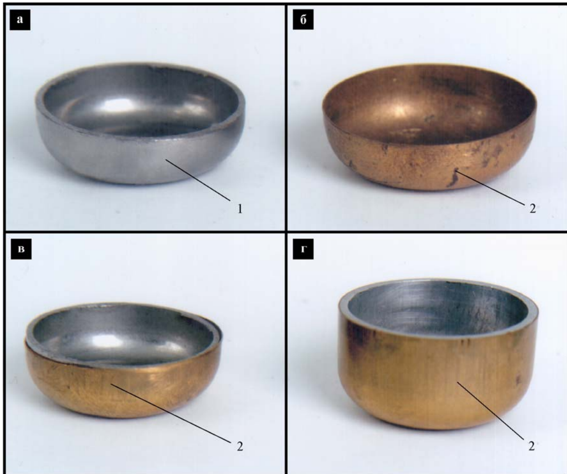
Рис. 3.60. Приклади витягування циліндричних сталевих деталей в захисній латунній оболонці: а – деталь зі знятою оболонкою; б – оболонка деталі «а»; в, г – деталі в оболонках; 1 – поверхня без подряпин; 2 – поверхня з подряпинами
