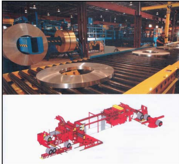
Рис. 13. Лінія поздовжнього різання рулонного матеріалу компанії Red Bud Industries
