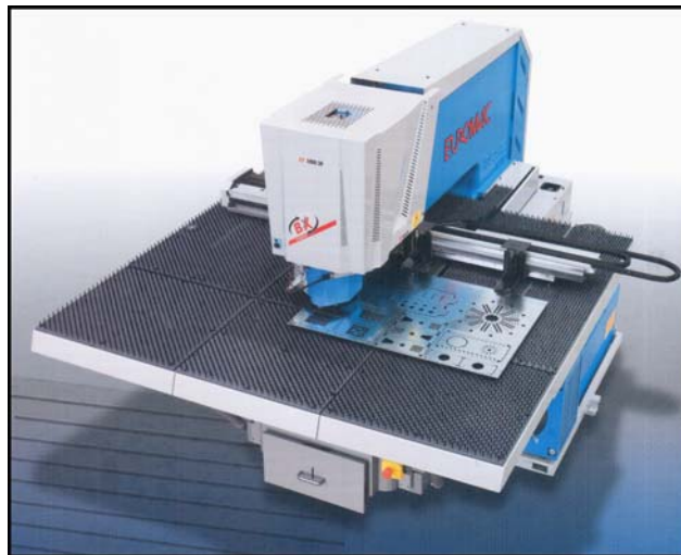
Рис. 8. Координатно-пробивний прес EUROMAC з ЧПК моделі BX AUTOINDEX. Зусилля 30 кН
