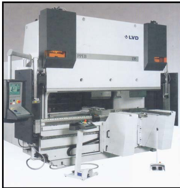
Рис. 9. Гідравлічний листогнуттєвий прес LVD PPEB з ЧПК
