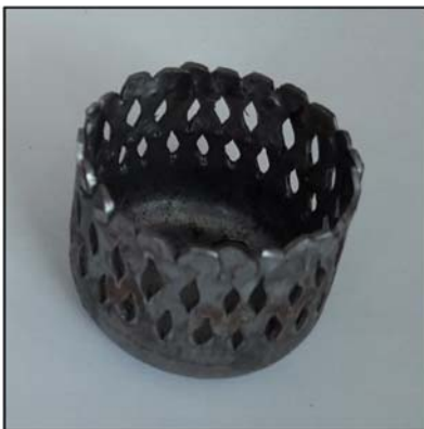
Рис. 3.67. Деталь, що витягнута із перфорованої круглої металевої листової заготовки (див. рис. 3.66)
