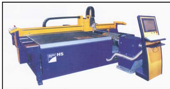
Рис. 11. Машина плазмового різання серії HS. При різанні сталі, товщиною 6 мм, на силі струму 130 А, швидкість різання складає 4025 мм/хв.
