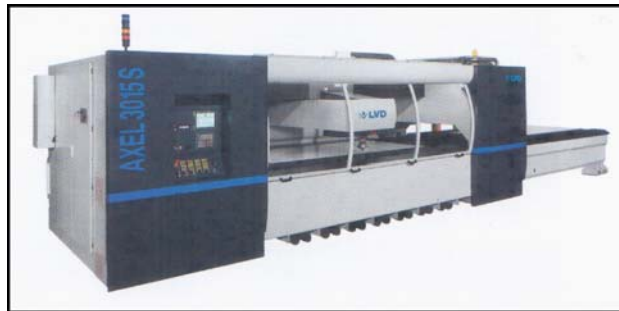
Рис. 7. Комплекс лазерного розкрою моделі Axel-S. Швидкість різання до 40 м/хв.
