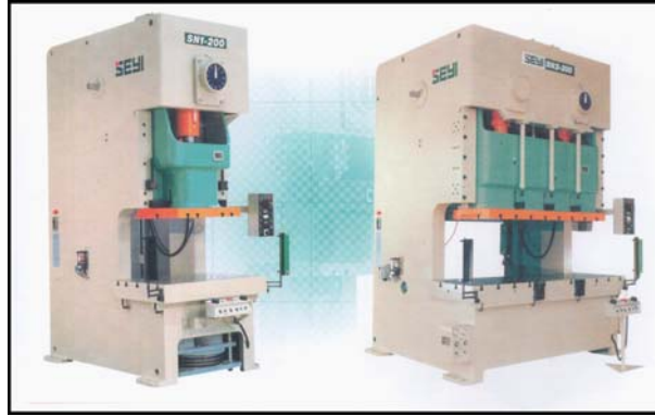
Рис. 12. Однокривошипний (ліворуч) та двох кривошипний (праворуч) преси, відповідно серії SN1 та SN2, компанії SEY (Тайвань)
