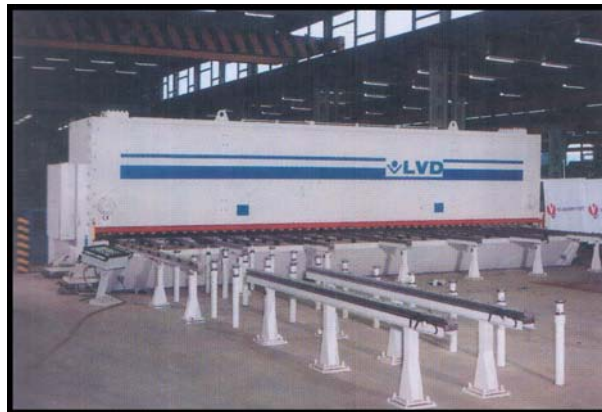
Рис. 10. Гідравлічні гільйотинні ножиці LVD MVS 8/140. Довжина різа 14 м, товщина різа 8 мм. Програмне забезпечення ширини різу та кута нахилу ножів
