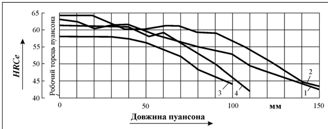
Рис. 5.43. Діаграма розподілу твердості за довжиною пуансона (сталь ШХ9) при його відпусканні: 1 – пуансон D = 50 мм, l = 150 мм; 2 – пуансон D = 18,7 мм, l = 150 мм; 3 – пуансон D = 50 мм, l = 100 мм; 4 – D = 50 \times 50 мм, l = 110 мм
