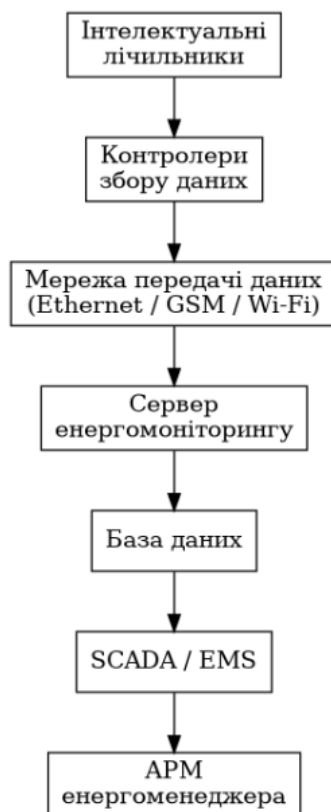
Рисунок 7.8 – Структурна схема системи Smart Metering підприємства
