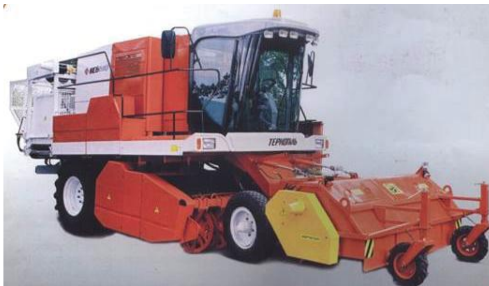
Рис. 2.6. Комбайн бурякозбиральний КСБ-6-10 "Тернопіль".
