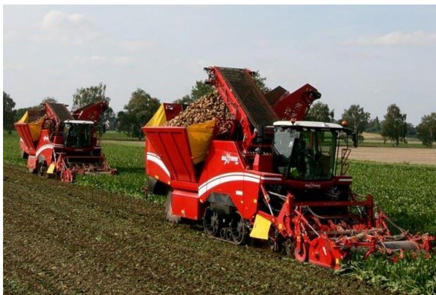
Рис. 2.11. Бурякозбиральний комбайн Grimme Maxtron 620 .
