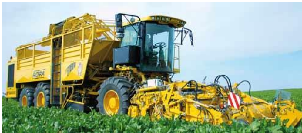
Рис. 2.8. Бурякозбиральний комбайн RopaEuro-TigerV8-4 .
