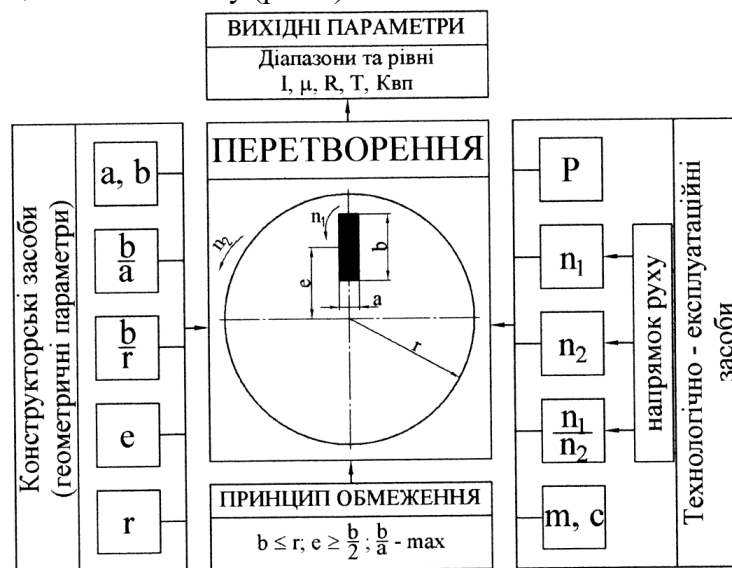
Рисунок 2 – Фізична модель впливу масштабного фактору на процеси в зоні фрикційного контакту: N – зусилля навантаження на зразок, m – мастило, n_1, n_2 – частоти обертання зразка та контртіла, a, b – розміри досліджуваного зразка, r – розмір контртіла спряженого зразка (диску), e – ексцентриситет, I_u – інтенсивність зношування, f_{mp} – коефіцієнт тертя, R – параметр контактного електроопору, T_{mp} – температура в зоні тертя, K_{en} – коефіцієнт взаємного перекриття.
