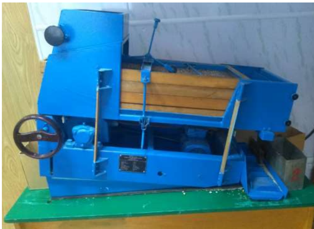
Рис. 3.11. Лабораторна установка «Плоскорешітний сепаратор зерна»
