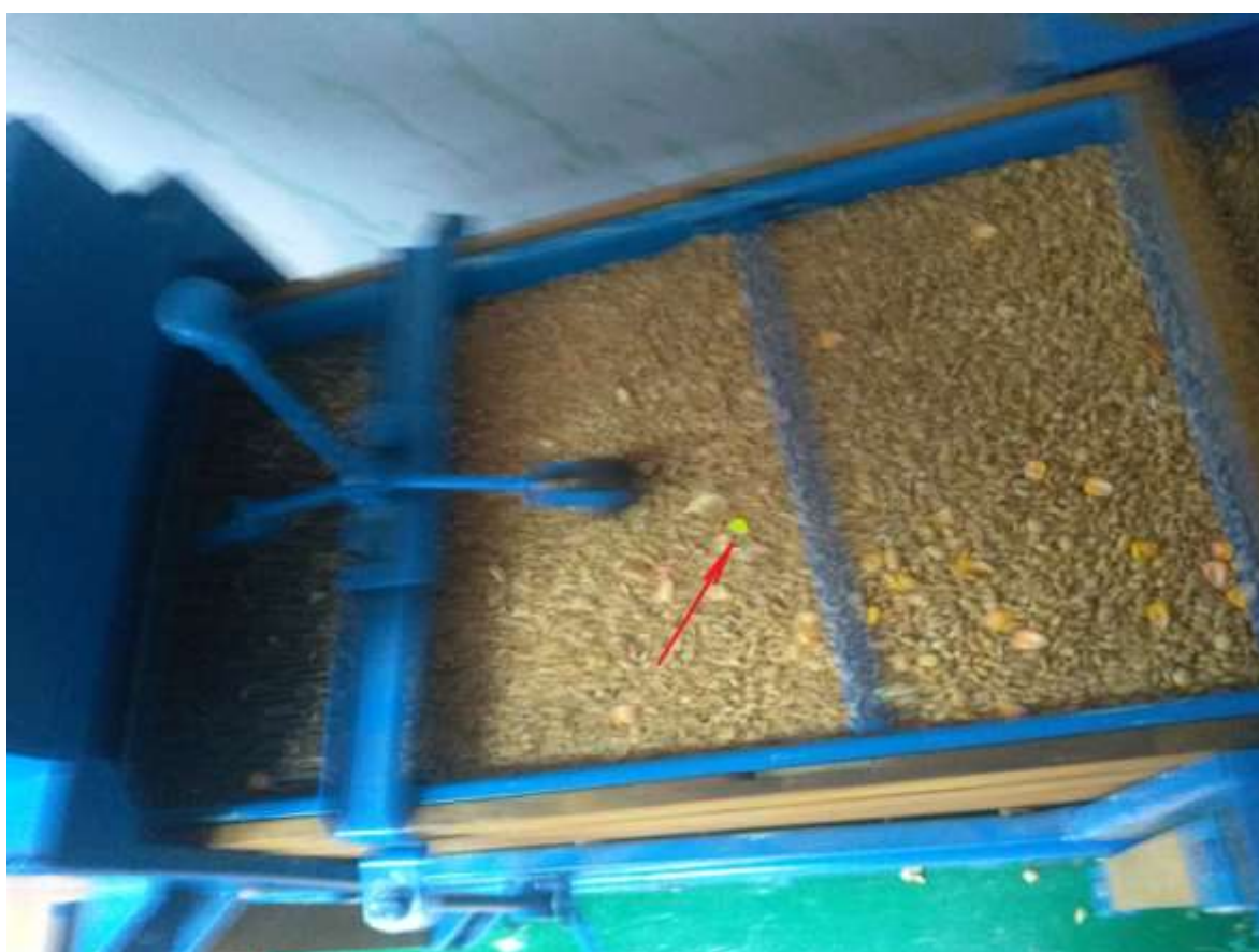
Рис. 3.11. Визначення часу переміщення фарбованої насінини по решету сепаратора
