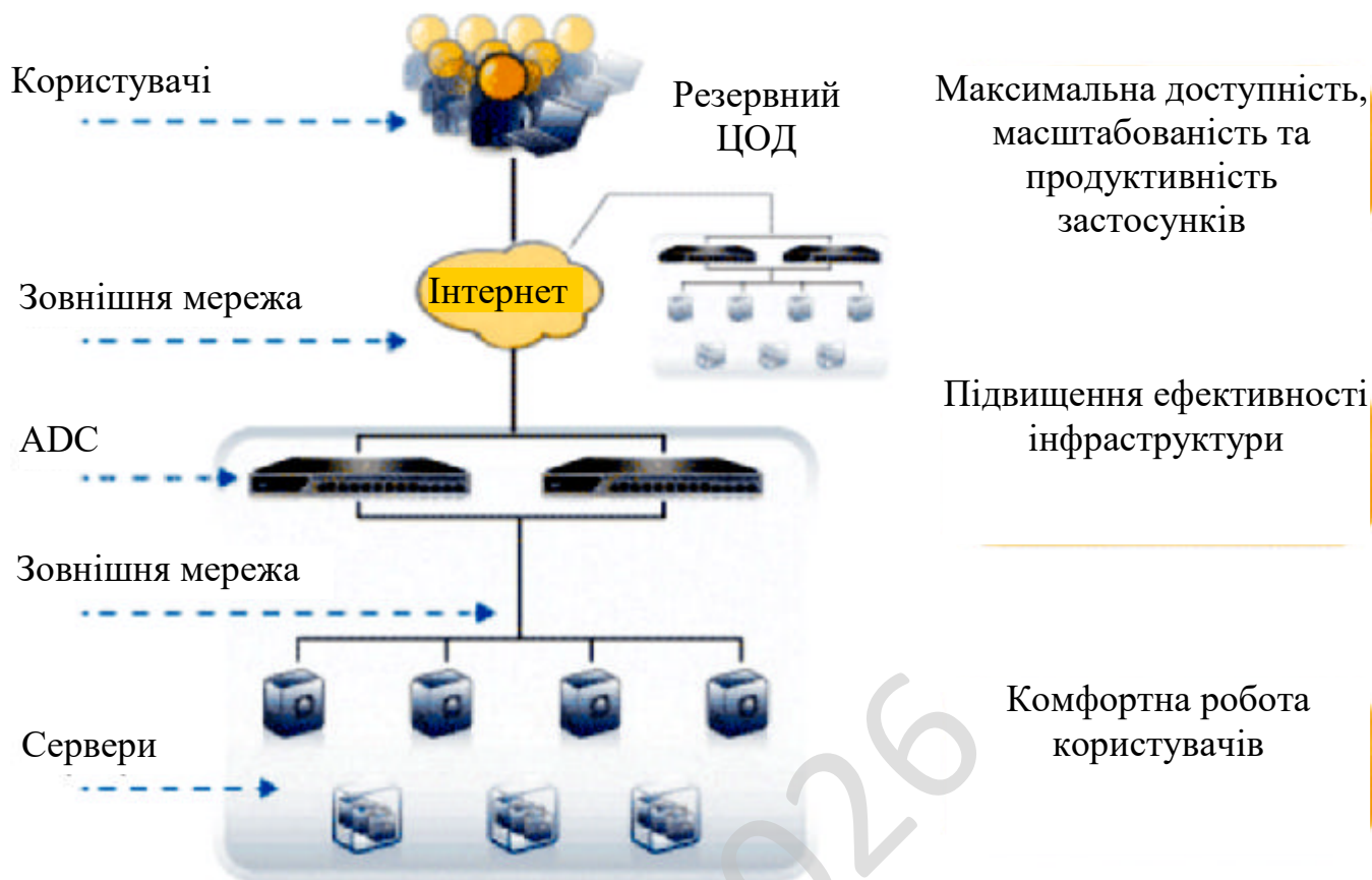
Рисунок 3.1 – Структурна схема системи
