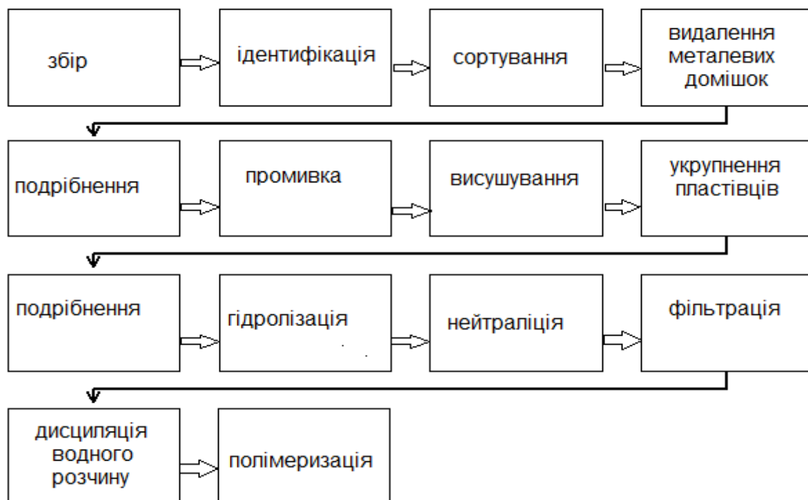
Рис. 2.3 – Типова схема утилізації під час використання хімічного методу
