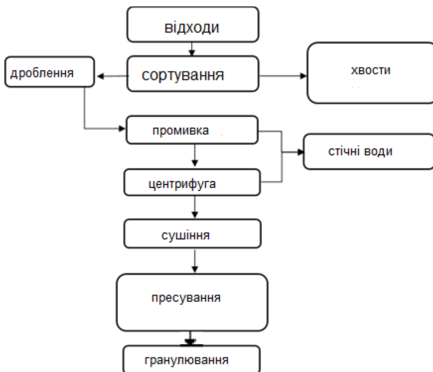
Рисунок 2.2 – Схема переробки відходів ПНД
