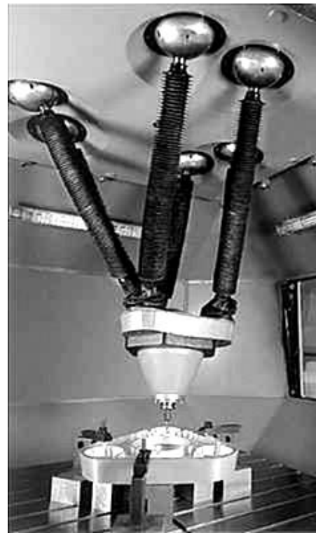
Рис. 6.8. Верстат-гексапод мод. TORNADO 2000 фірми HEXEL (США): а – загальний вигляд; б – робоча зона
