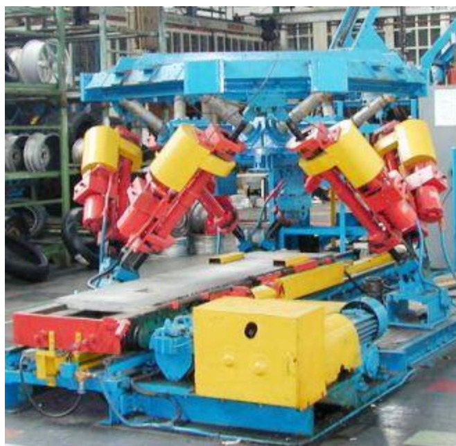
Рис. 3.3. Платформа Гауфа: а – механізм 1954 р.; б – сучасна модифікація 2000 р.
