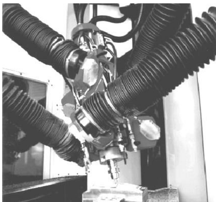
Рис. 6.3. Компонівка верстата-гексапода мод. 6X (а) і його робоча зона (б)
