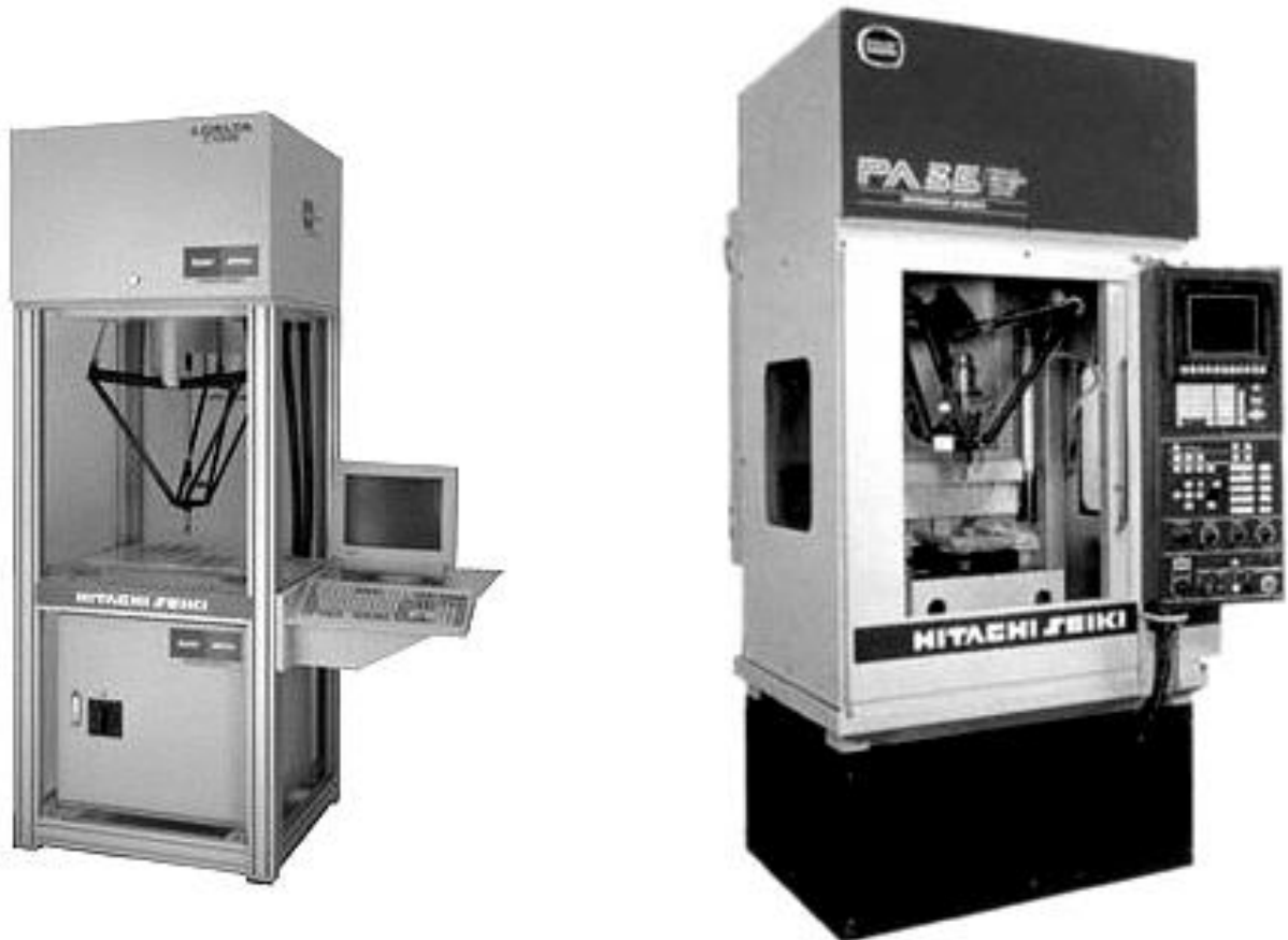
Рис. 6.20. Технологічне обладнання з паралельною кінематикою типу «дельта» для складальних робіт (а) та свердління (б) фірми HITACHI SEIKI (Японія)
