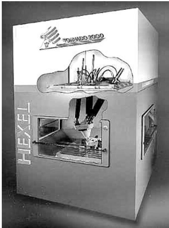
Рис. 6.8. Верстат-гексапод мод. TORNADO 2000 фірми HEXEL (США): а – загальний вигляд; б – робоча зона
