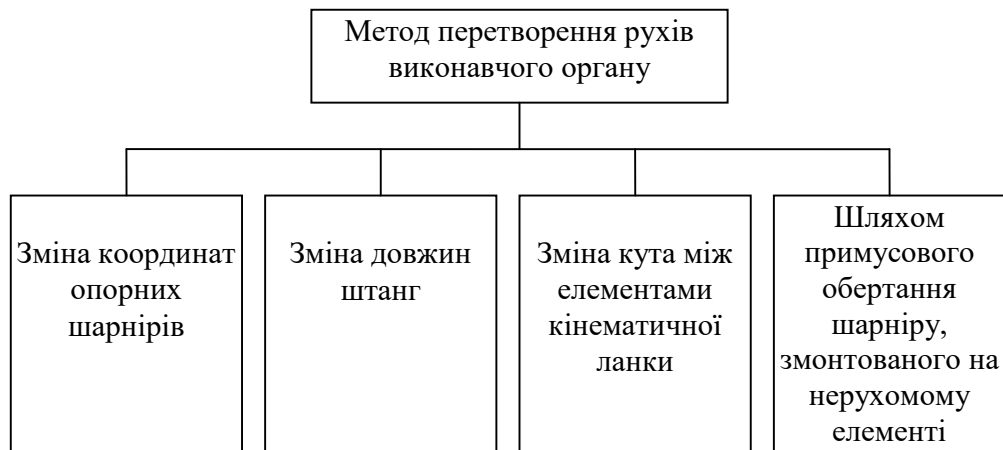
Рис. 3.11. Класифікація механізмів паралельної структури за методом перетворення рухів виконавчого органу
