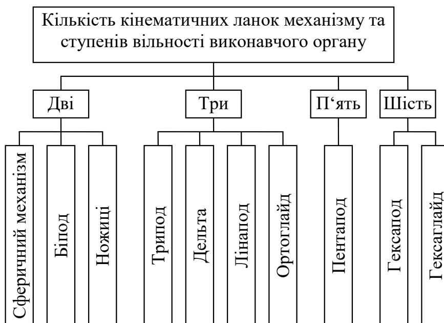
Рис. 3.14. Класифікація технологічного обладнання з паралельною кінематикою за кількістю кінематичних ланок та ступенів вільності
