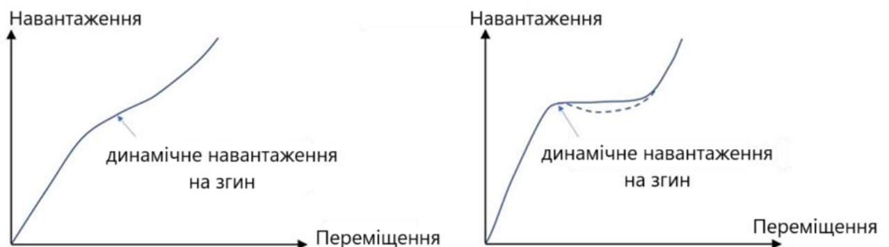
Малюнок 1.14. Співвідношення навантаження-прогину, де точку динамічного навантаження на прогин можна побачити як для великих (ліворуч), так і для малих (праворуч) початкових недоліків.
