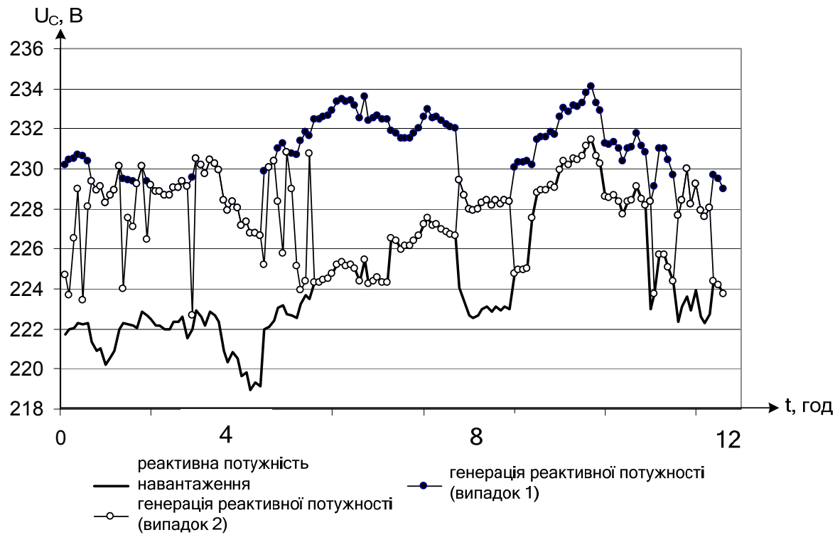
Рис. 4.12 Криві зміни напруги фази С до включення БК та після
