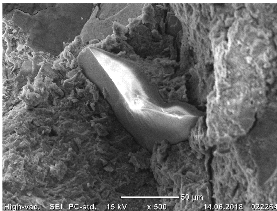
Рисунок 8 – Зерно скла в цементному камені зі збільшенням 500 раз
