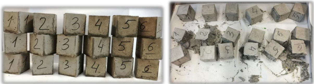
Рисунок 2 – Зовнішній вигляд бетонних зразків до випробування та після
