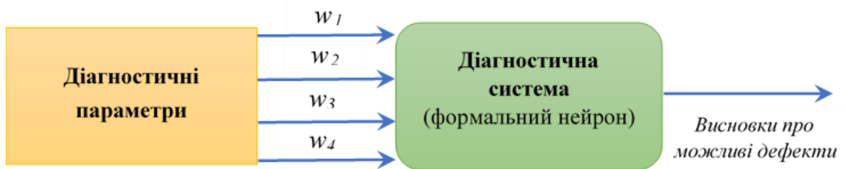
Рисунок 2.4 – Схема діагностичної моделі оцінки стану обладнання
