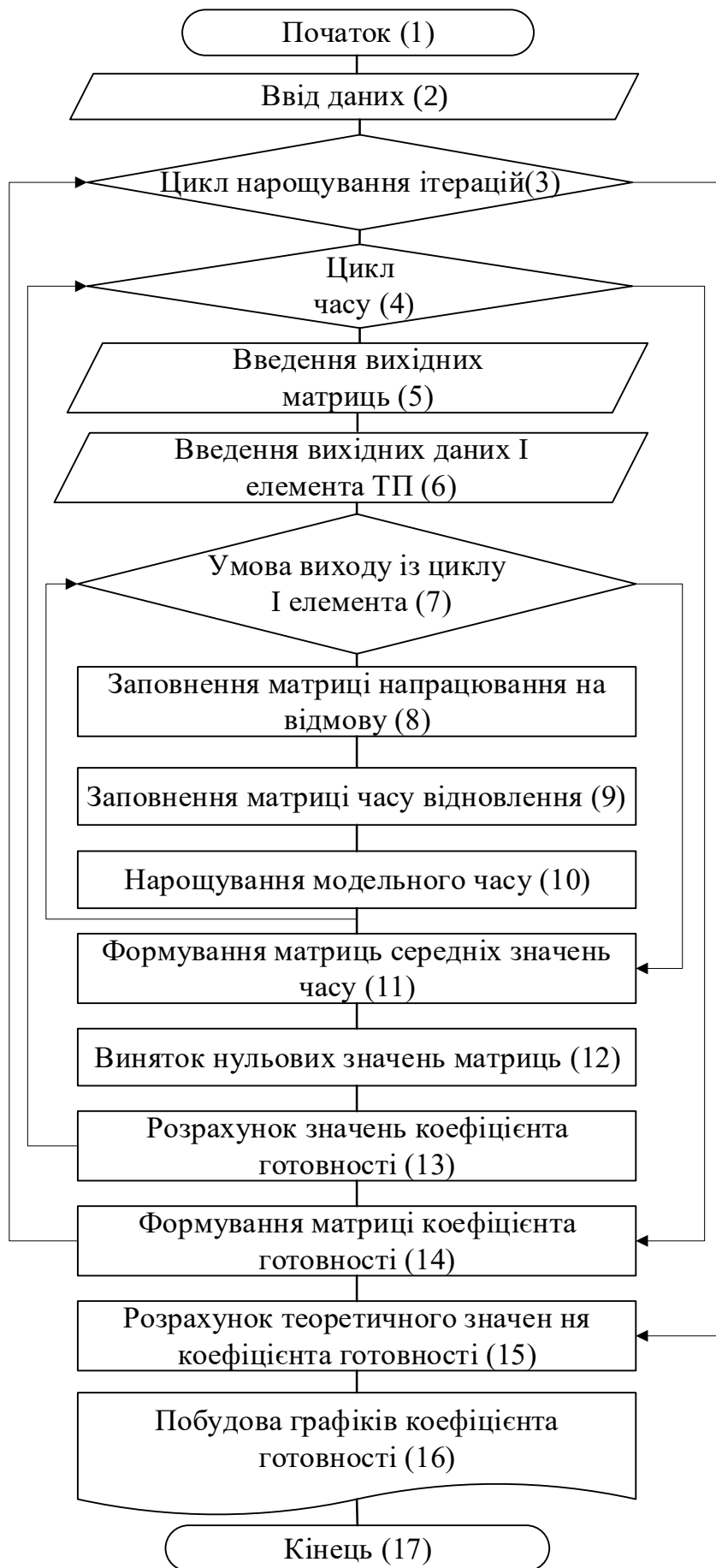
Рисунок 3.8 - Блок-схема програми для моделювання значення коефіцієнта готовності КТП 10/0,4 кВ
