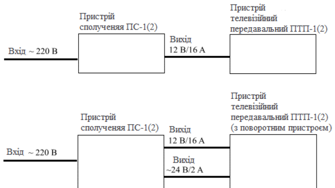
Рисунок 2.2 Структурна схема електроживлення ПС-1(2), ПТП-1(2)
