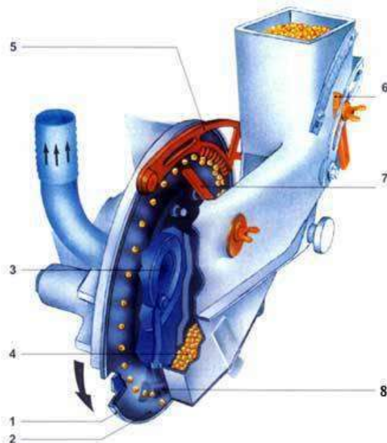
Рис. 3.32. Схема роботи висівного апарата сівалки СТВ–8К
