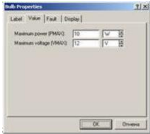
Рис 5 - Вікно встановлення параметрів лампи розжарювання
