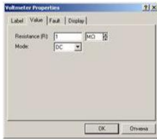
Рис. 2 - Вікно встановлення параметрів вольтметра
