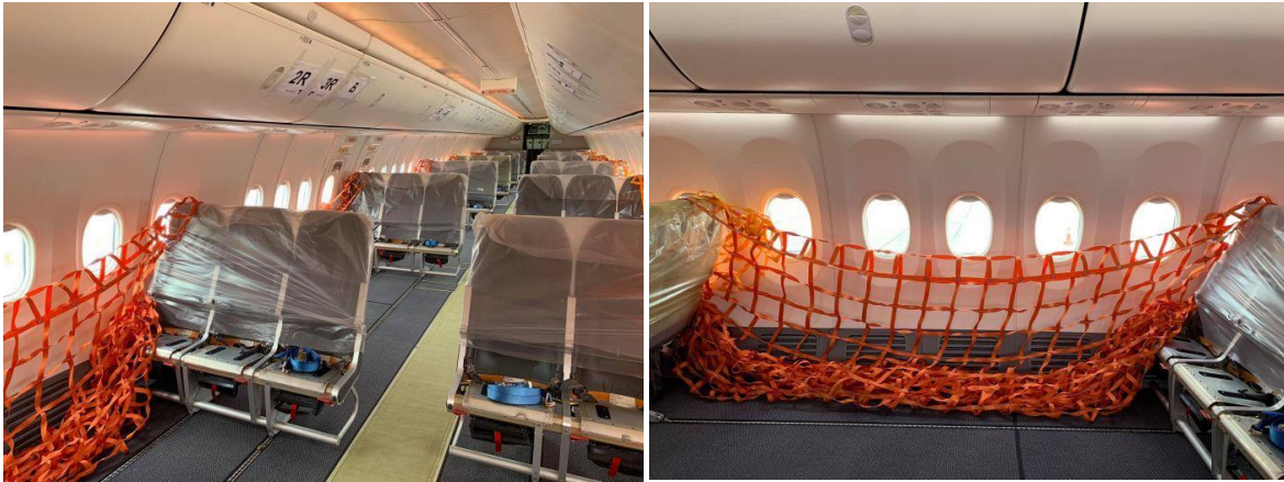
Рис. 3.3 Реконфігурація пасажирських літаків ТОВ «SkyUP» під вантажоперевезення
