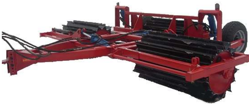
Рис.3.1. Коток-подрібнювач рослинних решток КП-4,5
