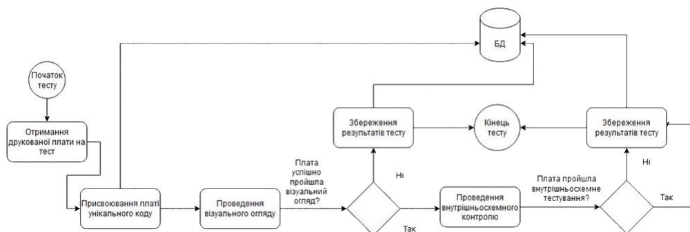
Рисунок 2.3 – Загальний базовий принцип процесу тестування друкованих плат
