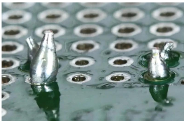
Рисунок 1.13 - Недостатньо флюсу, або погане змочування між припоєм та площадкою
