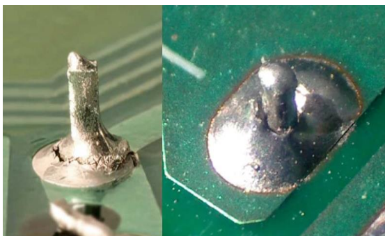
Рисунок 1.5 - Дефект холодна пайка та кільцеві тріщини
