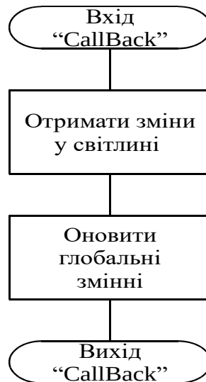
Рисунок 4.3 - Блок-схема роботи функції отримання повідомлень від сервера
