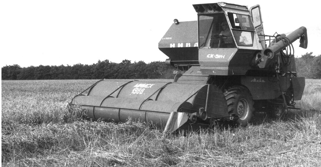
Рисунок 1 – Общий вид очесывающего устройства МОН-4,0 конструкции МИМСХ
