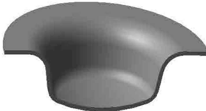
Рисунок 1.2 – Параметрична тривимірна модель деталі "Ковпачок" (розріз)
