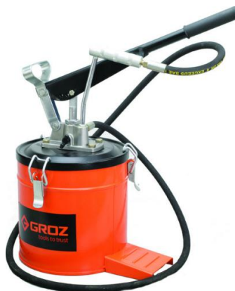
Рисунок 4.31 - Ручний нагнітач пластичного мастила.
