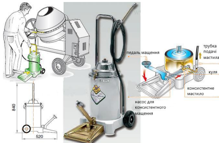
Рисунок 4.32 – Ножний нагнітач пластичного мастила.
