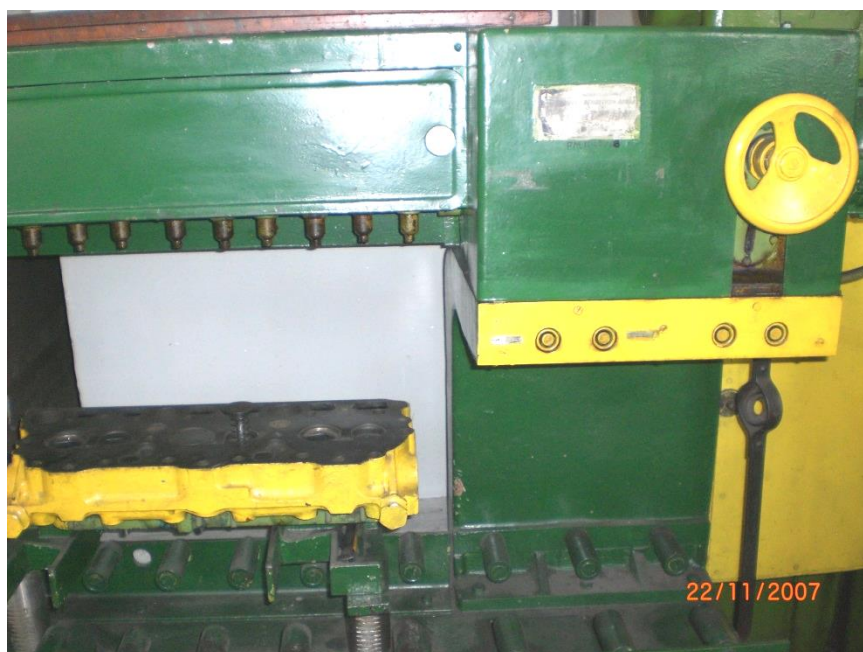
Рис. 5.5. Верстат для притирання клапанів ОПР-1841А
