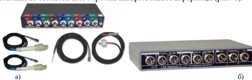
а - MLab MT-Pro; б - USB Autoscope; Рисунок 1 - Автомобільні осцилографи
