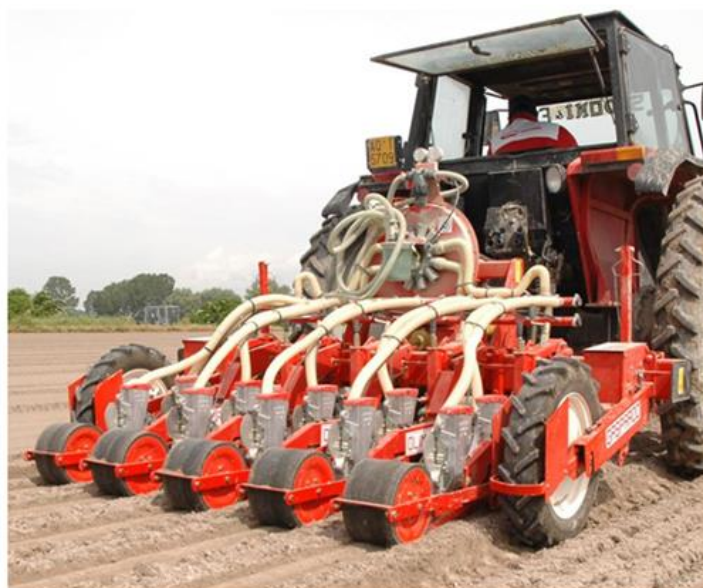
Рис. 2.1. Сівалка овочева точного висіву Gaspardo «Olimpia».
