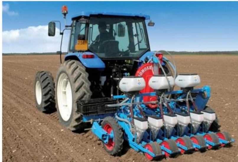
Рис. 2.2. Сівалка овочева точного висіву Monosem-MA
