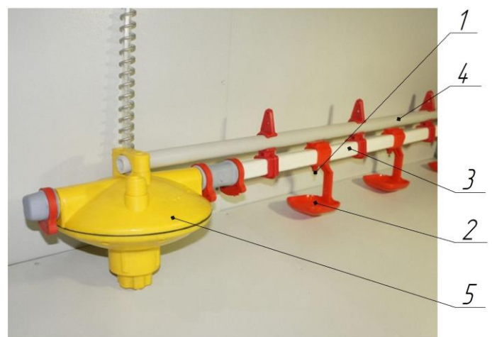
Рис. 1.6. Лінія напування птахів з ніпельною системою: 1 –ніпель; 2 – каплеуловлювач, 3 – трубопровод живильний; 4 – штанга, 5 – регулятор тиску.
